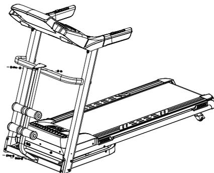
第五步：安装按摩头。取出按摩头，将其放在按摩架组件的耳片位置处。用3个M8X16外六角螺丝带垫片将其锁紧。如下图所示：
