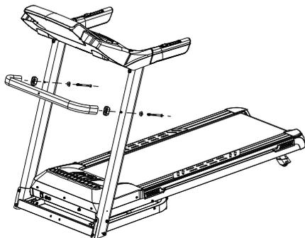
第四步：安装按摩头支撑架。用 1 个 M8X60 盘头内六角螺丝带垫片将按摩头支撑架锁在按摩头横管焊件上，再用 2 个 M8X45 盘头内六角螺丝带垫片将按摩头支撑架锁在底架的横管中间位置上，如下图所示：
