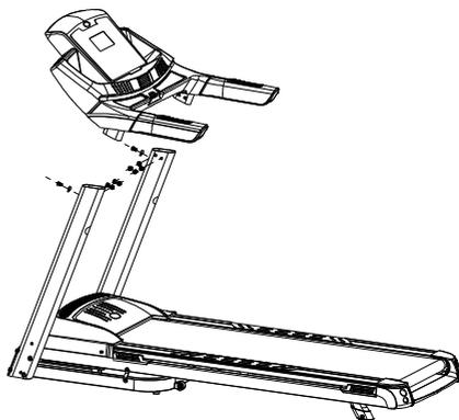
第三步：安装按摩头横管焊件。将按摩头横管焊件(带上弯管套)取出,用 2 个 M8X120 盘头内六角螺丝带弧形垫片将组件锁在左、右立杆架上，如下图所示：
