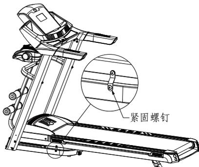
第八步：仔细检查跑步机各部分是否紧固，低速启动跑步机，检查跑带各部分是否转动灵活，跑带的松紧是否适当，以跑带不偏移，不打滑为准（见“电动跑步机日常保养与维护”）。检查完毕，将跑步机移至适当的位置，就可以投入使用了。
