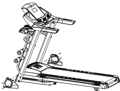
第六步：将防跳耳片上的紧固螺钉扭松并取下，收纳保管。然后将跑台折叠起来后若发现其不在左右扶手的中心位置，则松开前面步骤的螺丝，调整好跑台与扶手左右两边的距离相等后逐个拧紧螺丝。如下图所示：
