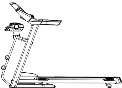
第七步：安装立脚靴。用4个M4×8大扁头十字螺丝，将左右脚靴按配合位固定。如下图所示：
