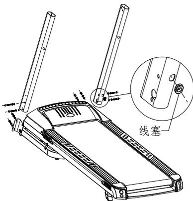
第二步：安装电子表。将立杆内的线与表线接好，然后将电子表组件插入到左右立杆内，再用 6 个 M8X16 盘头内六角螺丝带垫圈将表架固定在左右立杆上。如下图所示：
