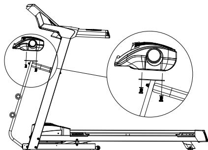
第六步：将防跳耳片上的紧固螺钉扭松并取下，收纳保管。将跑台折叠起来后若发现其不在左右扶手的中心位置，则松开前面步骤的螺丝，调整好跑台与扶手左右两边的距离相等后逐个拧紧螺丝。如下图所示：
