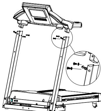
第三步：安装按摩头横管焊件。将按摩头横管焊件（带上弯管套）取出，用 2 个 M8X95 盘头内六角螺丝带垫片将组件锁在左、右立杆架上，如下图所示：
