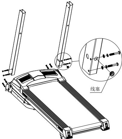
第二步：安装电子表。将立杆内的线与表线接好，然后将电子表组件插入到左右立杆内，再用 6 个 M8X16 盘头内六角螺丝带垫圈将表架固定在左右立杆上。如下图所示：
