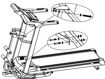
第五步：安装按摩头。取出按摩头，将其放在按摩架组件的耳片位置处。用 3 个 M8X16 外六角螺丝带垫片将其锁紧。如下图所示：
