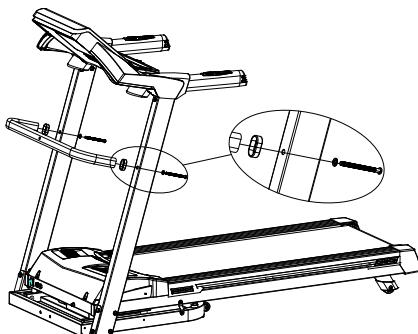
第四步：安装按摩头支撑架。用 1 个 M8X55 盘头内六角螺丝带垫片将按摩头支撑架锁在按摩头横管焊件上，再用 2 个 M8X40 盘头内六角螺丝带垫片将按摩头支撑架锁在底架的横管中间位置上，如下图所示：
