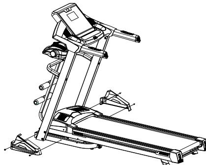
第八步：仔细检查跑步机各部分是否紧固，低速启动跑步机，检查跑带各部分是否转动灵活，跑带的松紧是否适当，以跑带不偏移，不打滑为准（见“电动跑步机日常保养与维护”）。检查完毕，将跑步机移至适当的位置，就可以投入使用了。
