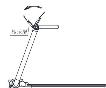
5.4 跑步机显示屏的折叠：双手扶住显示屏，轻微用力将显示屏往前推，旋转到位即可。
