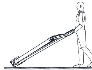
5.1 跑步机的移动：使用者站到跑步机的后端，双手抓住跑步机后端横杆，提起35°为宜，将跑步机推到合适区域后，平整放置。使用时跑步机后方需保留至少2000mm×1000mm安全区，避免跑步机使用时产生意外。
