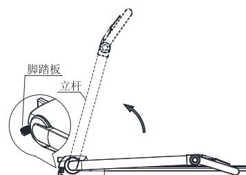
5.2 跑步机立杆的折叠：使用者站到跑步机的左边，右手扶住立杆轻微提起，左脚踩下跑步机前端的脚踏板，缓缓将立杆提起同时左脚离开脚踏板，当立杆旋转到位后，发出“咔嗒”的一响，表示锁紧到位。摇晃一下检查确定锁紧后才松手。当折叠时，右手扶住立杆，左脚踩下跑步机前端的脚踏板，缓缓将立杆放下，同时左脚离开脚踏板，当立杆旋转到位后，发出“咔嗒”的一响，表示锁紧到位。
