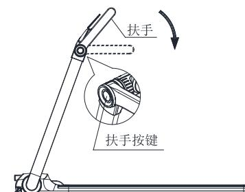
5.3 跑步机扶手的折叠：一边将跑步机扶手轻微提起，一边按下侧面的圆形扶手按键，此时扶手可进行旋转，旋转到一定角度后，可松开按键，旋转到位后，发出“咔嗒”的一响，表示锁紧到位。
