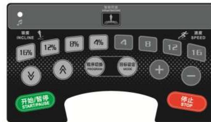
2. 1 “开始/暂停”键(Start/Pause)：在电源开启的情况下，按此键，可启动跑步机的运行；跑步机运行过程中，按此键，跑步机暂停，保留运行数据，再按一次此键，以刚才设置的参数继续运行。
